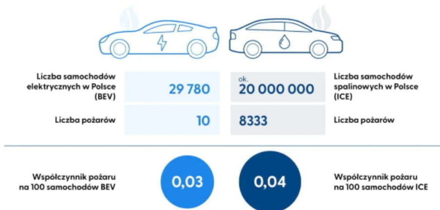
Rys. 4. Porównanie częstotliwości występowania pożarów samochodów typu BEV ze spalinowymi [13]
