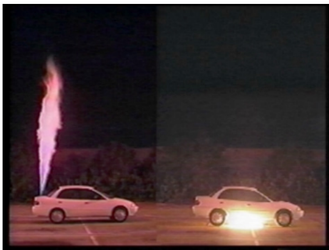
Rys. 5. Celowe rozszczelnienie zbiornika ze sprężonym wodorem po lewej i z benzyną po prawej [14]
