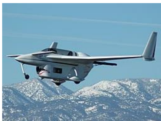
Rys. 2. Po lewej: bomba latająca V-1 (opracowanie własne), po prawej: zmodyfikowany Rutan Long-EZ napędzany pulsacyjnym silnikiem detonacyjnym (domena publiczna) [4]
