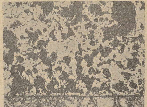
Rys. 3. Mikrostruktura brązu ołowionego 70% Cu, 30% Pb wylanego odśrodkowo na łuskę stalową i następnie wolno studzonego. Widoczna duża koagulacja ołowiu. Traw. elektrolityczne. Pow. 40 X
