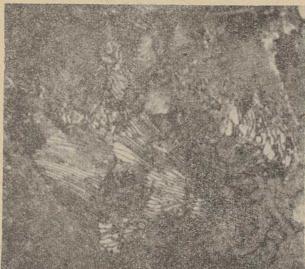
Rys. 7. Pow. 2500 \times . Struktura drobnego perlitu w stali zawierającej 0,67 % C, otrzymana podczas przemiany izotermicznej austenitu przy 595 °C
