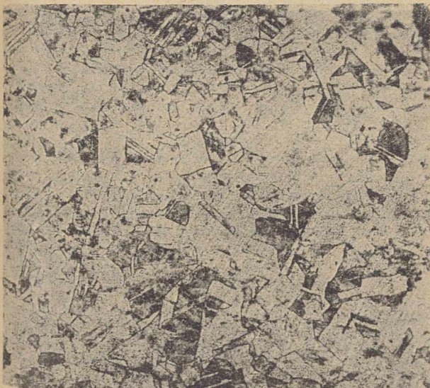
Rys. 3. 100 \times . Stal nierdzewna 18-8 polerowana mechanicznie
