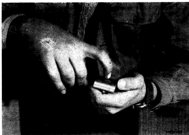
Rys. 9. Ocena gładkości powierzchni metodą dotykowo-przesuwną
