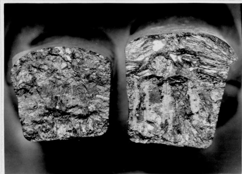
Rys. 39. Przełom prętów ze stopu wstępnego Cu-Ti o składzie eutektycznym. Pow. 2,5x.
