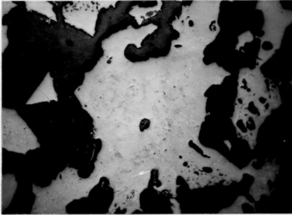
Koks z mieszanki o zawartości 70% węgla płomiennego, 30% E2
