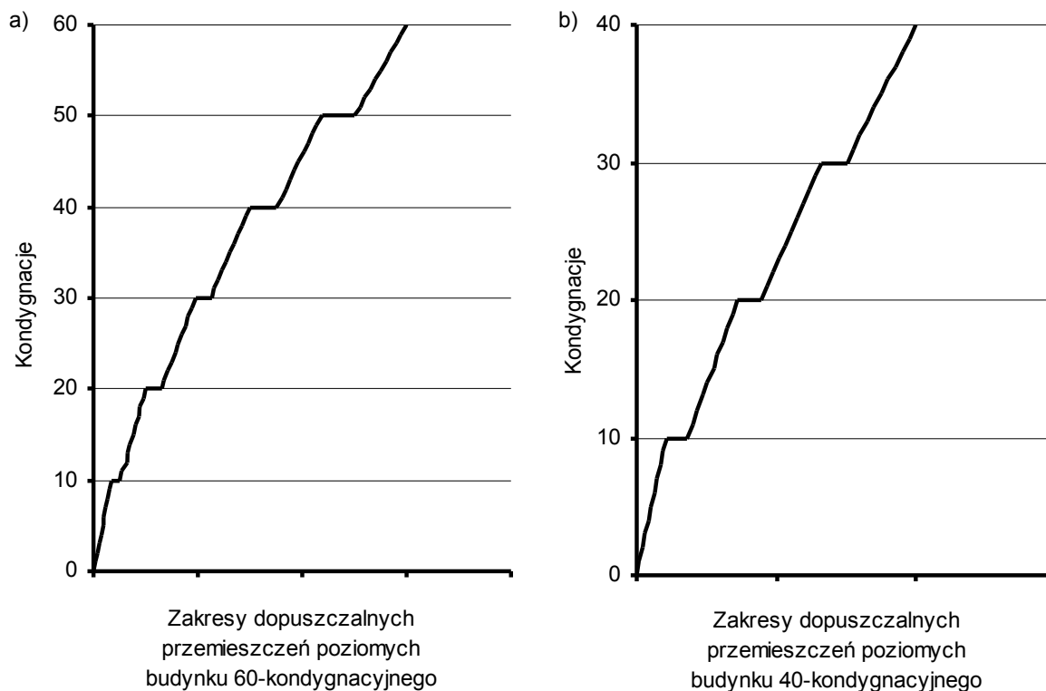
Rys.5.1. Wykresy zakresów dopuszczalnych przemieszczeń poziomych budynków wysokich wzdłuż ich wysokości: a) 60-kondygnacyjnego, b) 40-kondygnacyjnego
