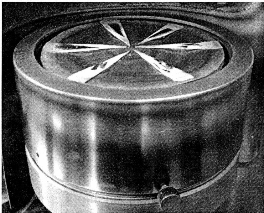
Rys. 4.2. Bazowy target tytanowy, na którego powierzchni są rozłożone kliny palladu i wanadu
