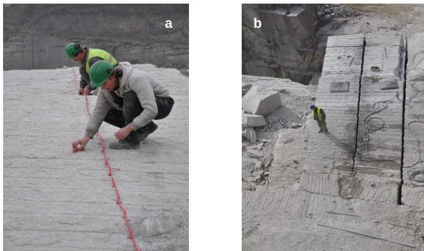
Rys. 5. Urabianie na bloki strzelaniem lontem detonacyjnym LD: a) załadunek LD w otworach pionowych, b) odspojony monolit po strzelaniu (fot. B. Korzeniowski)
