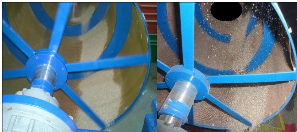
Rys. 7. Ruch warstwy ziarnistej w przesiewaczu bębnowo-kaskadowym
