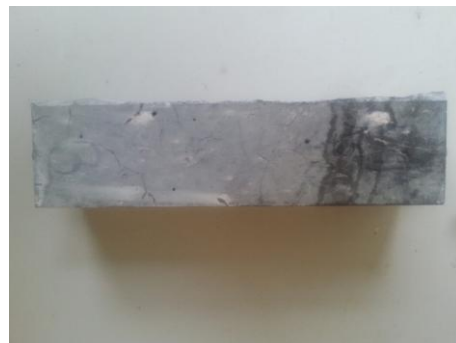
Rys. 5. Sieć drobnych spękań powstałych w trakcie badania wg AAR-5, kruszywo żwirowe 3 Fig. 5. Fine spider web cracks arise during AAR-5 test method, gravel aggregates-sample no. 3
