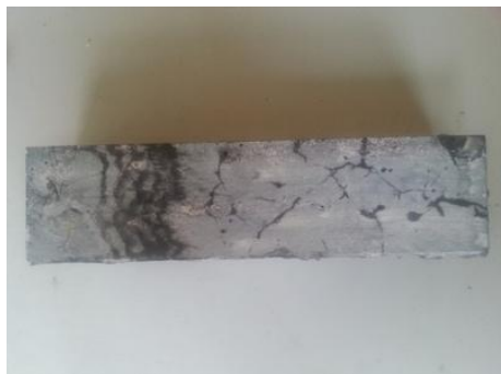
Rys. 4. Sieć drobnych spękań powstałych w trakcie badania wg AAR-5, kruszywo żwirowe 2 Fig. 4. Fine spider web cracks arise during AAR-5 test method, gravel aggregates-sample no. 2
