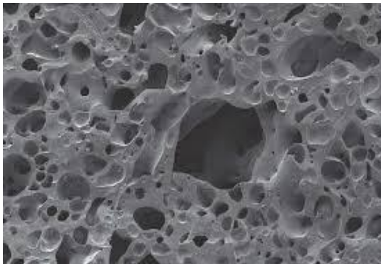
Rys. 1. Widok struktury betonu komórkowego
