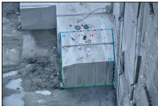
Rys. 12. Urabiania na bloki „z odsunięciem”; etapy: I – płaszczyzna pozioma, cięcie liną (kolor zielony), II, III – płaszczyzny pionowe, dwa prostopadłe cięcia liną (kolor niebieski), IV – wiercenie otworów niezbędnych do odsunięcia (fot. B. Korzeniowski)
