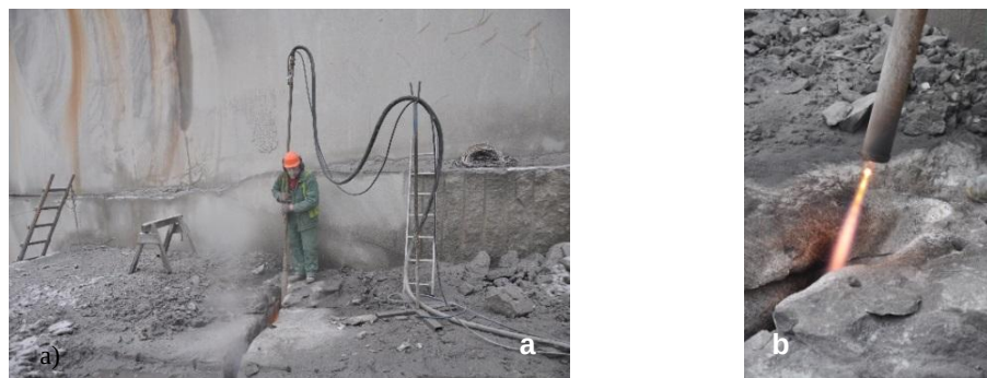
Rys. 2. Urabianie termiczne; a) wykonywanie wcinki palnikiem wrębowym, b) płomień palnika ze szczeliną wrębu (fot. B. Korzeniowski)
