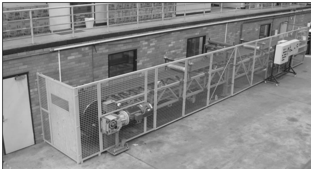
Rys. 3. Stanowisko do badań oporów toczenia taśmy po krążnikach na Uniwersytecie Newcastle (Wheeler & Munzenberger, 2011)
