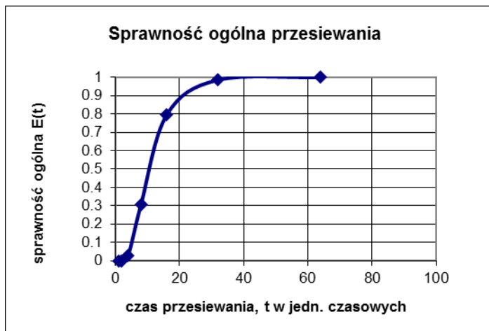
Rys. 5. Dokładność analizy sitowej mierzona sprawnością ogólną zależną od czasu przesiewania Fig. 5. Total recovery separation of n components to appropriate products dependent on endpoint of sieving
