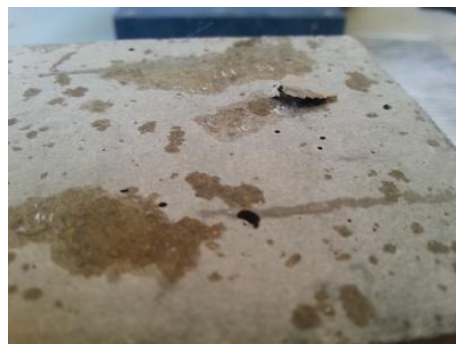
Rys. 3. Odpryski na powierzchni powstałe podczas badania wg AAR-4 na powierzchni, kruszywo 6 Fig. 3. Flakes came into view during AAR-4 test method, gravel aggregates-sample no. 6
