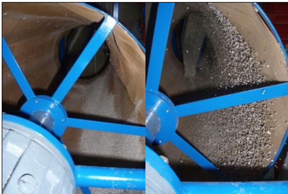
Rys. 3. Ruch warstwy ziarnistej w przesiewaczu bębnowo-stożkowym Fig. 3. Movement of grain layer in conical screen
