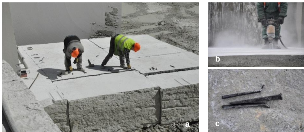
Rys. 1. Urabianie bloków klinowaniem; a) klinowanie ręczne b) wiercenie otworów pod kliny, c) klin trójdzielny (fot. B. Korzeniowski)
