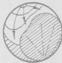
Rys. 68 Przykłady złomów zmęczeniowych próbek szlifowanych powlekanych Poliamidem M / \delta = 0,08 \text{ mm} /.
