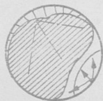
Rys. 69 Przykłady złomów zmęczeniowych próbek szlifowanych powlekanych Epidianem 1 / g = 0,18 \text{ mm/} .
