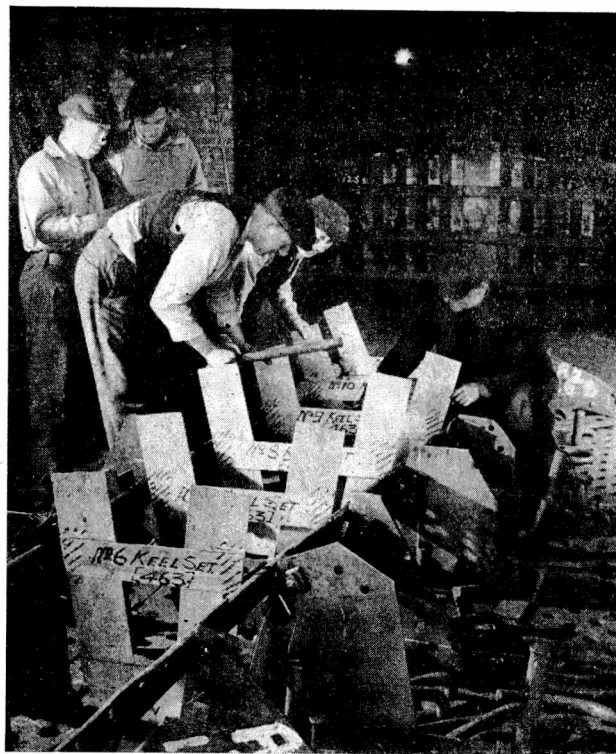
b) Prowizoryczne łoże do krępowania płytki stępkowej
