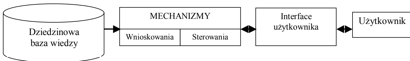
Rys. 3-4 Typowa struktura regułowego systemu eksperckiego. Źródło: [77]
