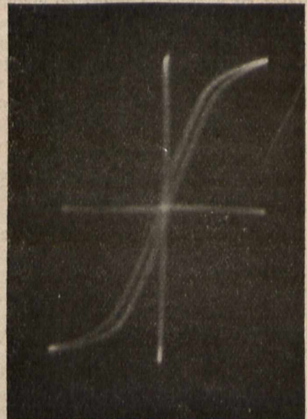
Rys. 18. Krzywa histerezy dla próbki z blachy żelaznej — f = 50 okr/sek.
