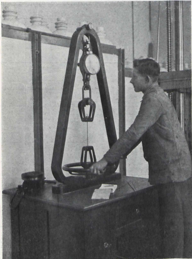
Rys. 15. Przyrząd dynamometryczny do badania wytrzymałości przewodników podług § 3 „Przepisów technicznych na linie elektryczne napowietrzne”. Konstrukcje i wyrób Gródka.
