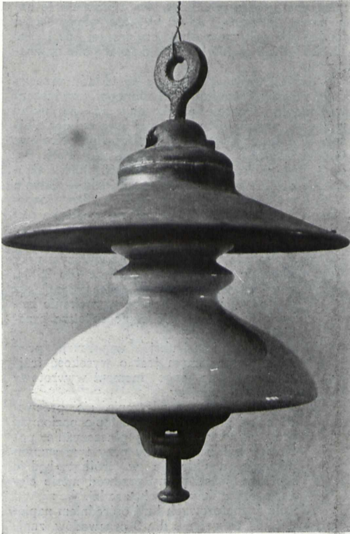
Rys. 8. Masywny izolator wisiorowy typu „Hoffmann” dla napięcia roboczego 35 kV. Przeskok na sucho — 130 kV, na mokro — 95 kV.
