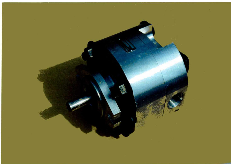
Rys.53. Widok ogólny modelu pompy gerotorowej z kompensacją luzów osiowych
