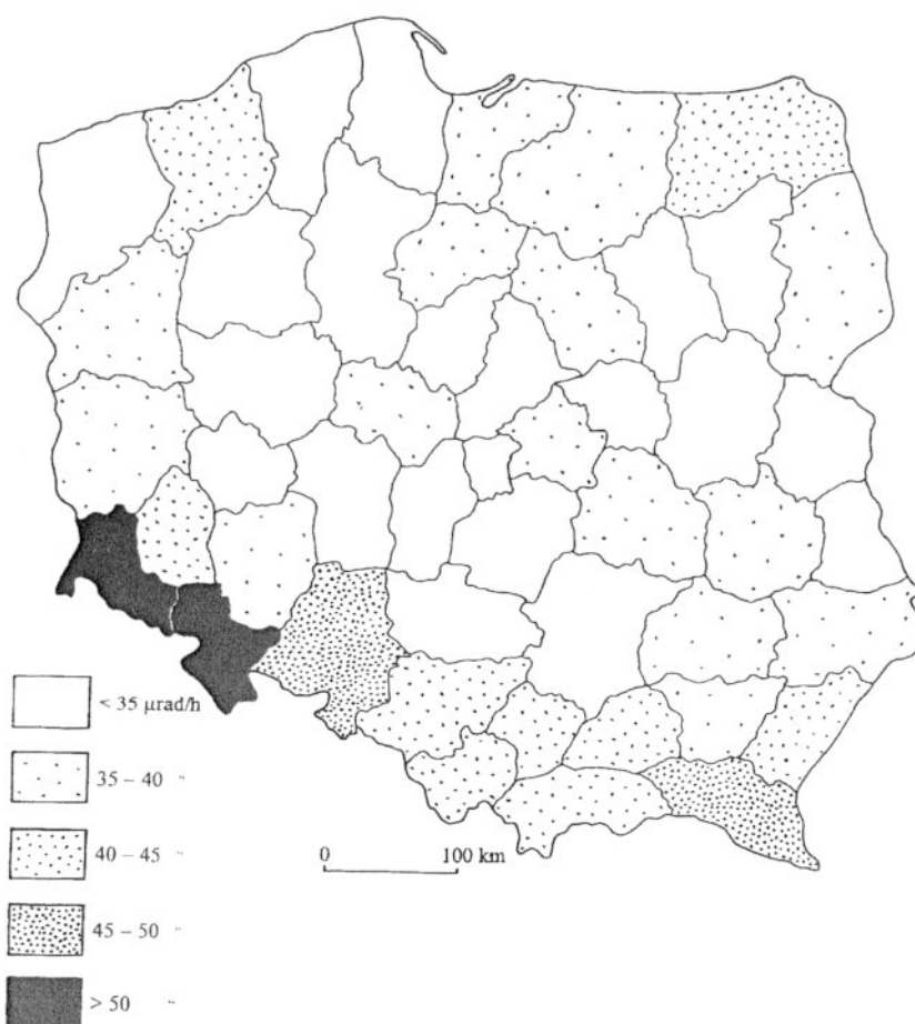
Rys. 4.1. Średnie moce dawki pochłoniętej na zewnątrz budynków spowodowane naturalnymi źródłami promieniowania w Polsce (według [336]).
