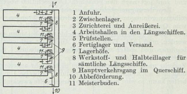
Abb. 177a. Flachbau-Werkanlage in Kammanordnung mit allgemeiner Stoffbewegung in Richtung der Querschiffachse.
