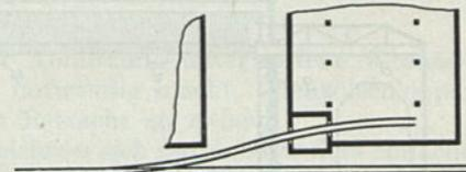
Abb. 9c. Windschleuse für Eisenbahnwagen in dreischiffiger Werkstatthalle eingebaut. M. 1 : 2000.
