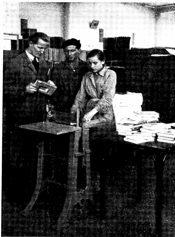
Ob. Oskędra (z lewej), autor projektu aparatu do rowkowania, bada jakość wpalonych rowków
