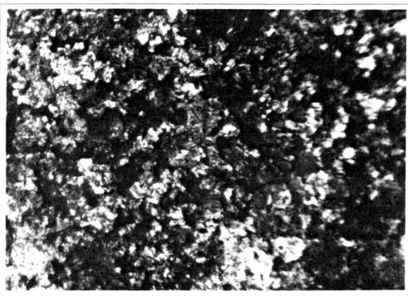
Rys. 98. Struktura rdzenia stali Cr-Mn-Mo (w. IIIC) po nawęglaniu w temp. 920^\circ\text{C} i hartowaniu. Pow. 500x.
