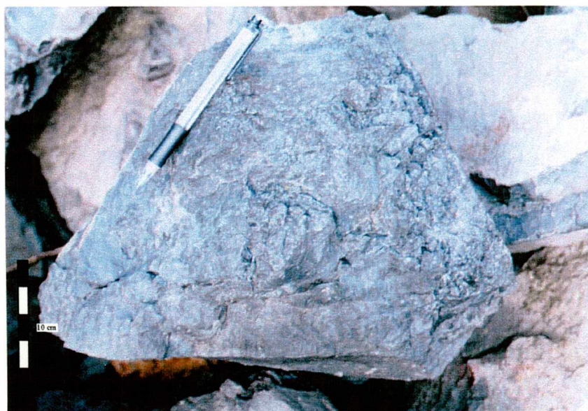
Fot. 29. Nieregularne strefy występowania „plamek” zgorzelowych w słupie bazaltowym (Targowica)
