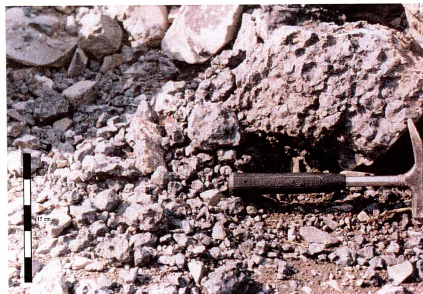
Fot. 20. Produkty samoczynnego rozpadu skały zgorzelowej (Trupień)
