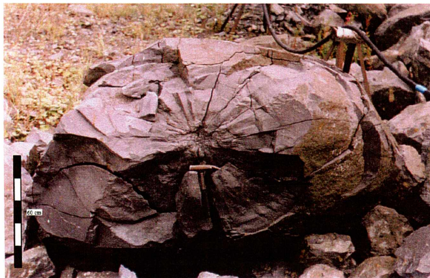
Fot. 40, 41. Zgorzel w strefie przylegającej do miejsca wybuchu; rezultat strzelania nakładkowego (Księginki)
