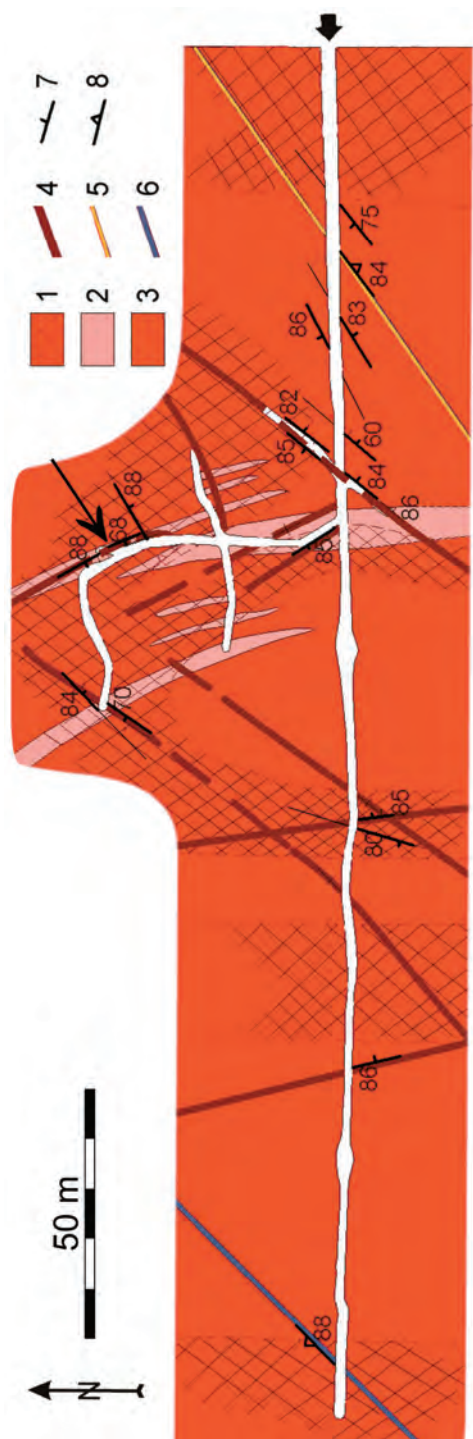
Ryc. 13. Mapa geologiczna Sztolni nr 1 w Bobrowie; 1 – granity silnie zwietrzałe, 2 – granit wysokoskaleniowy, 3 – granit porfirowaty, grubokrystaliczny, 4 – strefy uskokowe, 5 – mikrogranit, 6 – lamprofir, 7 – orientacja spękań, 8 – orientacja powierzchni kontaktowych skał żyłowych, położenie wystąpienia episenitu wskazano strzałką
