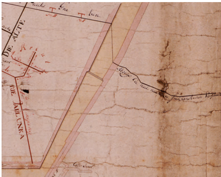
Ryc. 46. Sztolnia na planie podziemnej infrastruktury twierdzy kłodzkiej datowanym na koniec XVIII w., opisana jako Abzugs Canal nach dez. Frankensteiner Vorstadt (Plan zur Einverstaendigung, b.r.)
