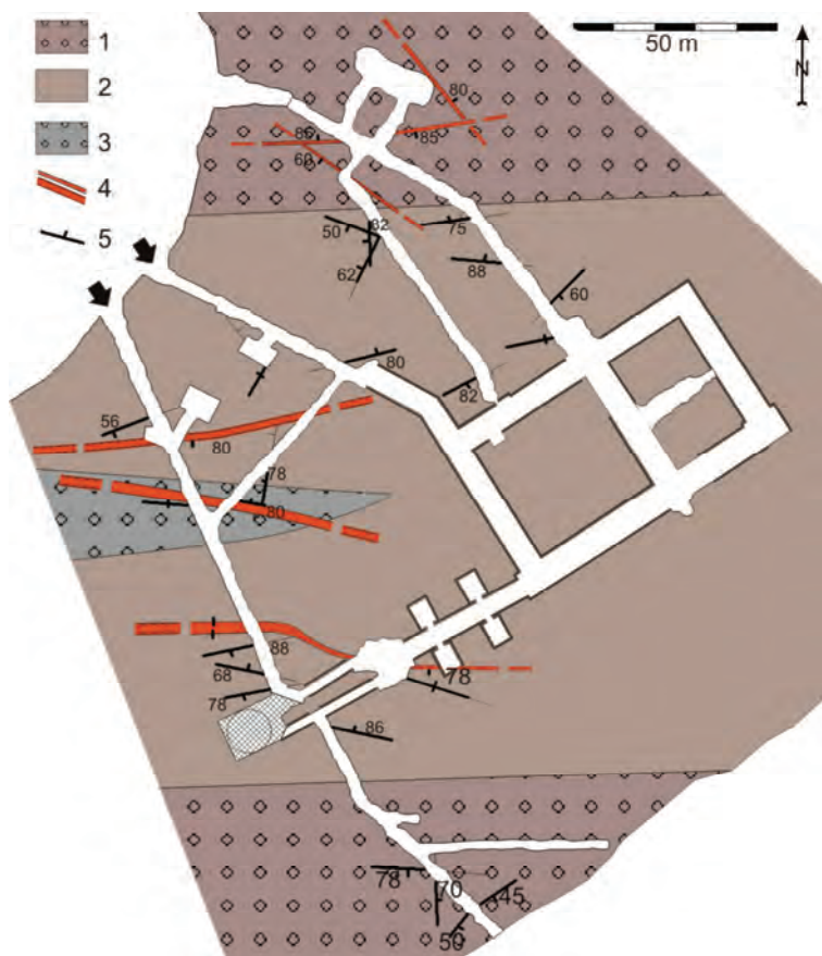
Ryc. 86. Uproszczona mapa geologiczna podziemi zamku Książ (poziom główny); 1 – zlepieńce polimiktyczne, 2 – piaskowce, częściowo z otoczkami, 3 – zlepieńce mułowcowe, 4 – szerokie strefy uskoku, 5 – uskoki (podkład – według planu Kaszy i in., 2018, zmodyfikowany)
