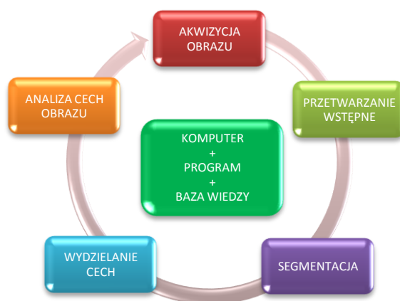
Rys. 2.1 Komputerowy system analizy obrazu.
