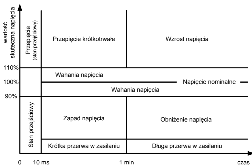
Rys. 3.3 Klasyfikacja zakłóceń ze względu na wartość napięcia oraz czas trwania zaburzenia [95].
