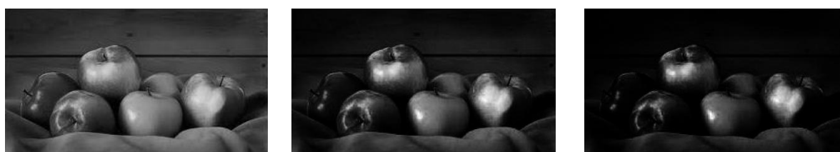
Rys. 2.26 Wynik przekształcenia obrazu za pomocą funkcji potęgowej. Kolejno: obraz oryginalny, obraz przekształcony za pomocą funkcji potęgowej o współczynniku k = 2 , obraz przekształcony za pomocą funkcji potęgowej k = 3 .
