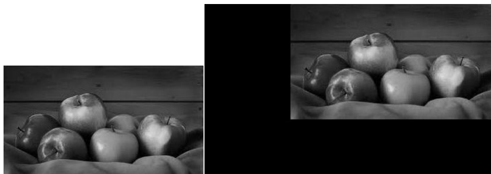
Rys. 2.17 Obraz źródłowy (po lewej) i obraz wynikowy (po prawej) powstały po przesunięciu o m = 80 wierszy i n = 120 kolumn.
