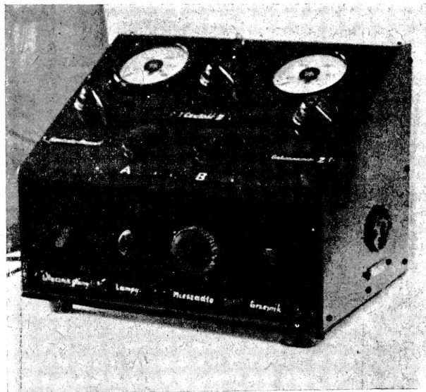
Rys. 2. — Potencjometr lampowy do miareczkowania potencjometrycznego.
