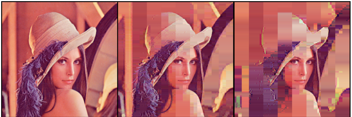
Rys. 3.5. Obraz wejściowy (po lewej) po przetworzeniu transformatą DWT (i odwrotną – IDWT) z użyciem POI (punkt fiksacji zdefiniowano na nosie modelki), dla wartości threshold określonej z wzoru (2). Obraz po środku: a=15 , b=0 , c=15 ; obraz po prawej: a=45 , b=0 , c=45 . (informacja o prawach autorskich do rysunku „Lena”: [68])
