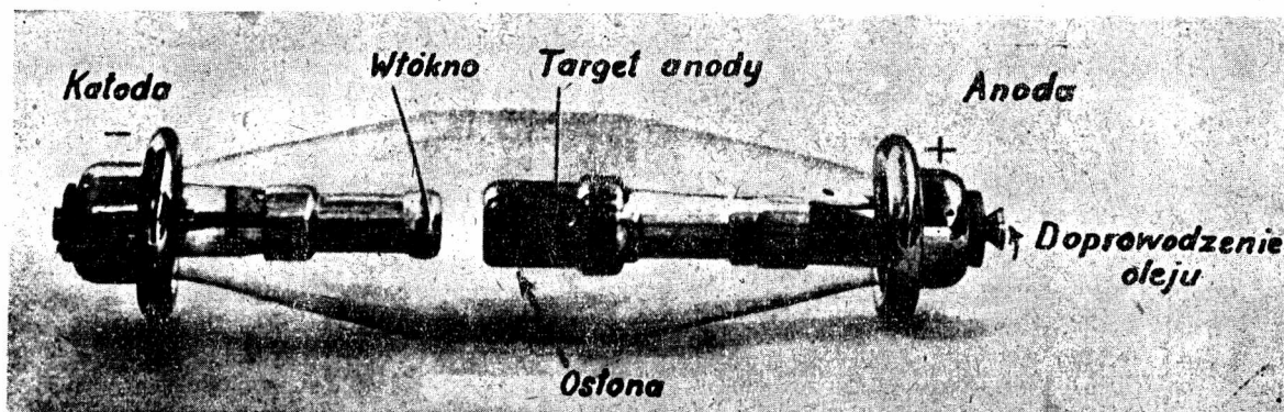
Rys. 2. Nowoczesna rura rentgenowska na 200000 V, stosowana w radiografii przemysłowej z izolacją i chłodzeniem olejowym. Target anody umieszczony jest w osłonie, promienie X wychodzą przez okienko berylowe.
