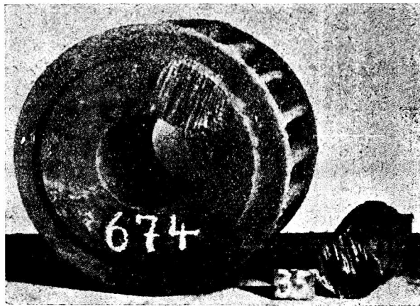
Rys. 5. — Koło zębate ze staliwa manganowego (12÷14% Mn).
