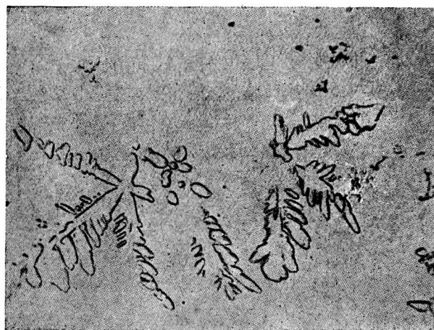
Rys. 7. Dendryty fazy alfa — Fe w stopie Cu-Fe 3,51. Powiększenie 150-krotne wg Hansona-Forda 11) .
