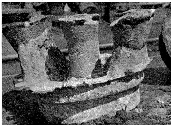
Rys. 13. Stosowany na zakładzie układ wlewowy.
