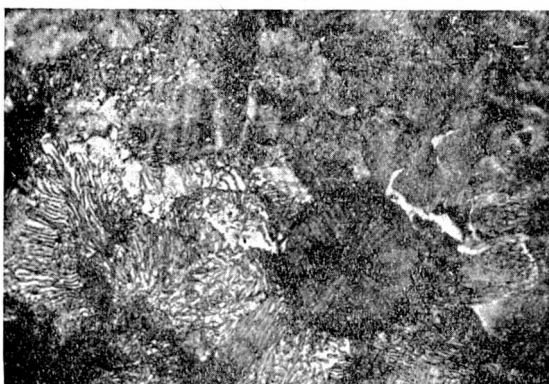
Rys. 7. Żeliwo sferoidalne otrzymane z żeliwiaka, trawione azotalem. Pow. 500 X
