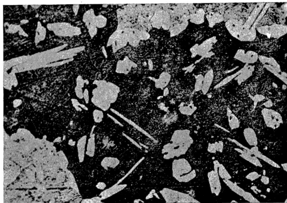
Rys. 1. Struktura mosiądzu specjalnego stosowanego na śruby napędowe pancernika „Bismarck”, pow. 100×, traw. FeCl 3 .
