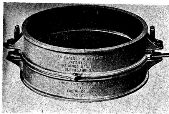
Rys. 5. Skrzynka zdejmowana okrągła ze sworzniowym urządzeniem ustalającym
