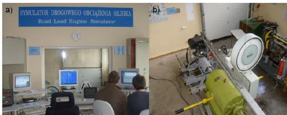
Rys. 7.1. Symulator obciążenia drogowego: a) pulpit sterowniczy, b) silnik spalinowy z maszyną prądu stałego
