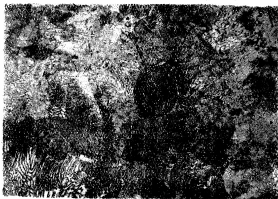
Rys. 7. Struktura żeliwa sferoidalnego, uzyskanego przez dodatek stopu MCN-20, traw. azot., pow. 500 ×
