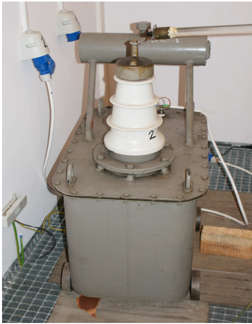
Rys. 7.2 Układ zasilający iskiernik modelujący WNZ, gdzie: a) transformator probierczy, b) pulpit sterujący.
