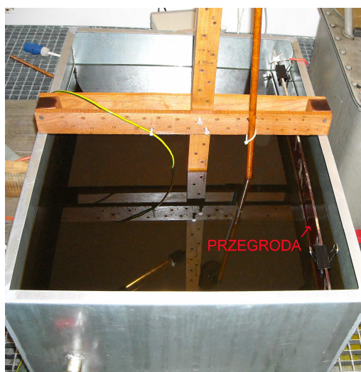
Rys. 7.29 Widok przegrody wykonanej z płyty tekstolitu o grubości 5 mm
