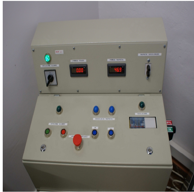
Rys. 7.2 Układ zasilający iskiernik modelujący WNZ, gdzie: a) transformator probierczy, b) pulpit sterujący.
