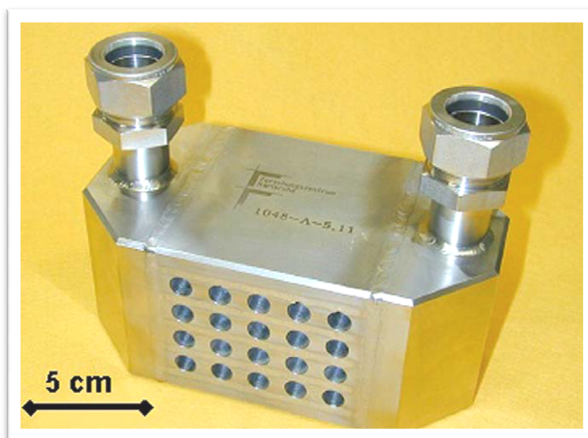
Rys. 3.9. Przykład mikrowymiennika stosowanego do produkcji biodiesla [7]
