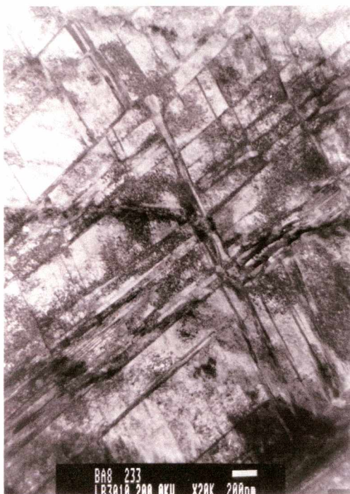
Rys. 6.2.1.14. Obraz struktury brązu aluminium CuAl8 po rozciąganiu ( \dot{\epsilon}_{pr} = 0,01 \text{ s}^{-1} ) z równoczesnym skręcaniem ( \dot{\epsilon}_{ps} = 0,1 \text{ s}^{-1} ) z amplitudą 0,11 do odkształcenia zastępczego 1,2 w temperaturze otoczenia (TEM)
