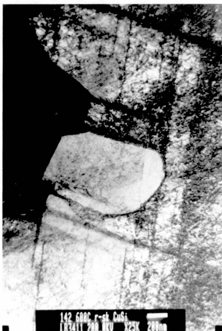
Rys. 6.1.2.14. Zarodek rekrytalizacji w strukturze brązu krzemowego \text{CuSi}_{3,5} po rozciąganiu ( \dot{\epsilon}_{pr} = 0,01 \text{ s}^{-1} ) z równoczesnym skręcaniem małowykłowym ( \dot{\epsilon}_{ps} = 0,1 \text{ s}^{-1} ) z amplitudą 0,11 do odkształcenia zastępczego 1,2 w temperaturze 600^\circ\text{C}
