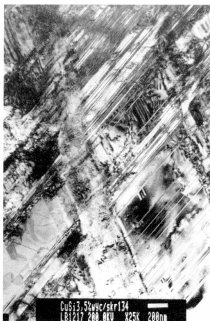
Rys. 6.1.1.16. Struktura brązu krzemowego \text{CuSi}_{3,5} po rozciąganiu ( \dot{\epsilon}_{pr} = 0,01 \text{ s}^{-1} ) z równoczesnym małocyklowym skręcaniem ( \dot{\epsilon}_{ps} = 0,1 \text{ s}^{-1} ) z amplitudą 0,11 do odkształcenia zastępczego 1,3 w temperaturze otoczenia (TEM)
