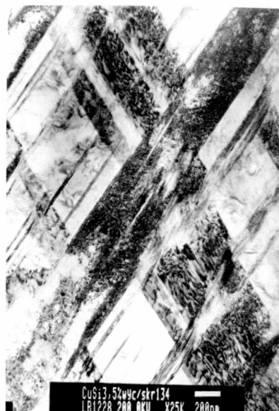
Rys. 6.1.1.30. Struktura brązu krzemowego CuSi 3,5 po rozciąganiu ( \dot{\epsilon}_{pr} = 0,01 \text{ s}^{-1} ) z równoczesnym małowykłowym skręcaniem ( \dot{\epsilon}_{ps} = 0,1 \text{ s}^{-1} ) z amplitudą 0,11 do odkształcenia zastępczego 1,3 w temperaturze otoczenia (TEM)
