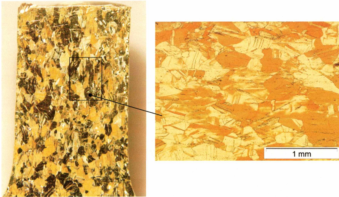
Rys. 5.2.1.4. Struktura brązu CuAl8 odkształconego w monotonicznej próbie rozciągania w temperaturze pokojowej z prędkością 0,1 \text{ s}^{-1} dla \epsilon_{pz} = 0,48
