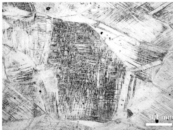
Rys. 6.1.1.23. Strukturę brązu krzemowego CuSi 3,5 po rozciąganiu ( \dot{\epsilon}_{pr} = 0,01 \text{ s}^{-1} ) z równoczesnym małowykłowym skręcaniem ( \dot{\epsilon}_{ps} = 0,1 \text{ s}^{-1} ) z amplitudą 0,11 do odkształcenia zastępczego 0,8 w temperaturze otoczenia
