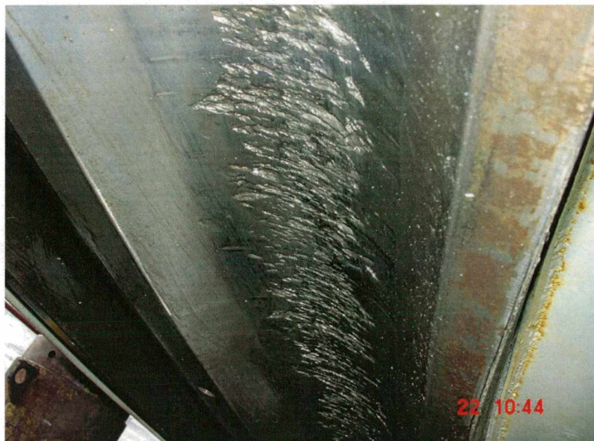
Rys. 6.1. Uszkodzenie górnej bieżni łożyska koparki SchRs 4600.30 w po kilkuletniej eksploatacji.
