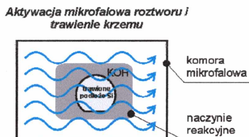
Rys. 2.3. Trawienie EMSi – jednoczesna aktywacja roztworu trawiącego mikrofalami i trawienie krzemu w obecności pola mikrofalowego
