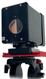
Rys. 3. Nadajnik i odbiornik zestawu do komunikacji laserowej AstroLight
