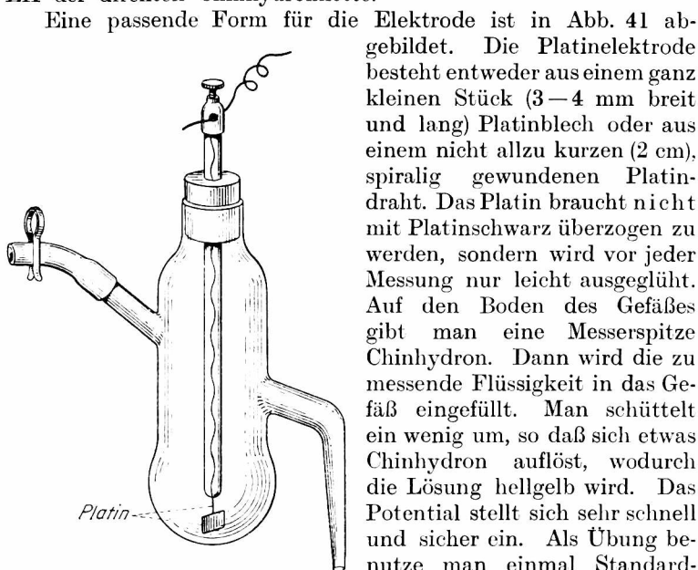
Abb. 41. Chinhydronelektrode \frac{1}{4} bis \frac{1}{2} nat. Größe.
