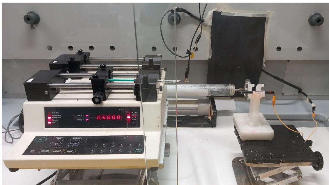
Schemat 37. Układ do elektroprzędzenia włókien z wykorzystaniem elektrody jako kolektora
