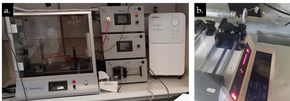
Schemat 18. Aparatura wykorzystywana do elektroprzędzenia: a. Spinbox; b. zestaw niekomercyjny
