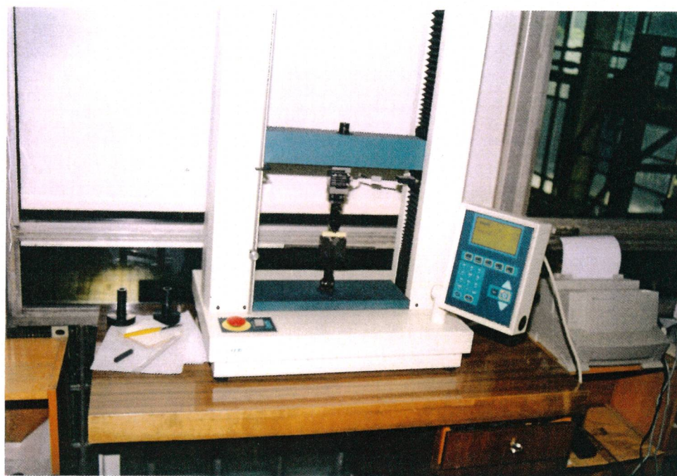
Rys. 4.9. Widok stanowiska badawczego do pomiaru współczynników sprężystości podłużnej E_{dm} przy zginaniu i E_{cm} przy ściskaniu.
