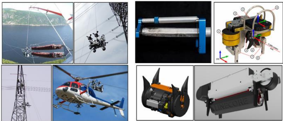
Rys. 4. Technika PPN w Kanadzie (z lewej) oraz liczne zastosowania sensorów wdrożone przez LineDrone na liniach czynnych (z prawej): mikro-omomierz LineOhm do złączek; Chronos, do precyzyjnego pomiaru ugięcia przewodu, Helios do ogólnego pomiaru temperatury (absorpcja słoneczna) oraz LineCore, czujnik prądów wirowych do wczesnego wykrywania oznak korozji przewodów [18]
