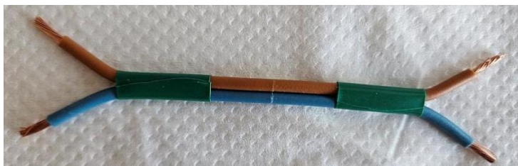
Rys. 9. Przykład przygotowanej próbki kablowej przed zwęgleniem
