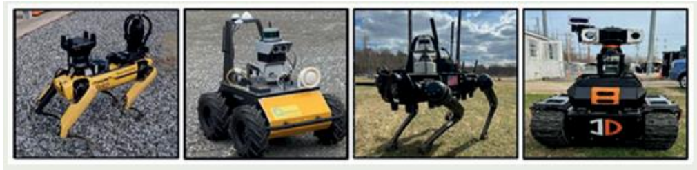
Rys. 7. Roboty przeznaczone do prac na stacjach elektroenergetycznych [20]
