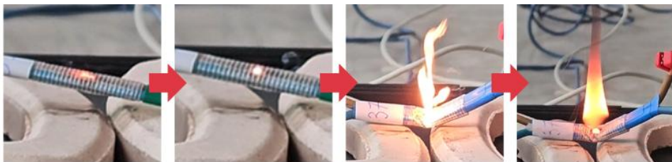
Rys. 11. Etapy rozwoju wyładowania łukowego
