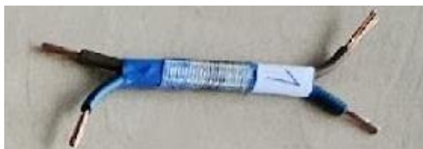
Rys. 10. Przykład próbki kablowej po zwęgleniu przygotowanej do badania
