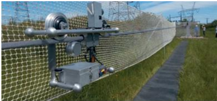
Rys. 8. Prezentacja przejazdu robota do diagnostyki przewodów z wykorzystaniem metod magnetycznych na stanowisku testowym RTE [21]
