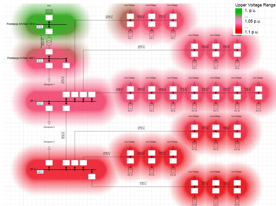
Rys. 1. Fragment sieci elektroenergetycznej z instalacjami fotowoltaicznymi
