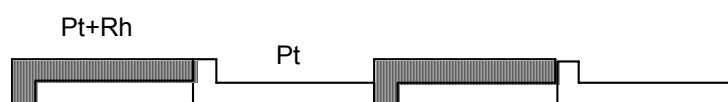
Rys. 2. Wstążka termostosu utworzona przez połączenie termopar Pt/Pt–Rh [43] Fig. 2. Thermopile ribbon formed by Pt/Pt–Rh thermocouples [43]
