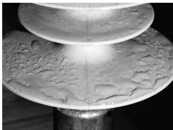
Rys. 9.12. Akumulacja wody przy krawędziach kloszy
