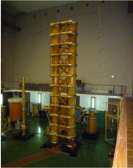
Rys. 8.3. Generator napięć uderowych GU1800 w Hali Wysokich Napięć PWr.: a) widok ogólny, b) schemat układu; M – układ napędu do regulacji odstępu iskierników I_w C_s – kondensatory, r , r_1 , r_2 – oporniki [63]
