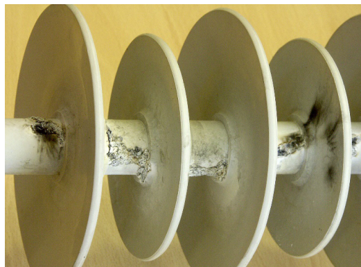
Rys. 9.21. Erozja osłony rdzenia 5-kłozowego izolatora umieszczonego w komorze deszczowej – 25. dzień próby starzeniowej
