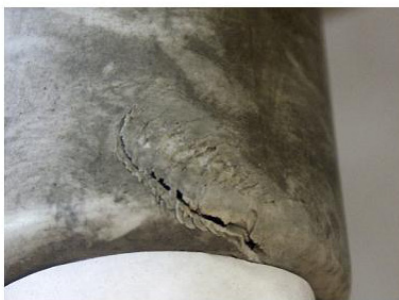
Rys. 12.3. Niebezpieczne pęknięcie kompozytowej osłony przy okuciu
