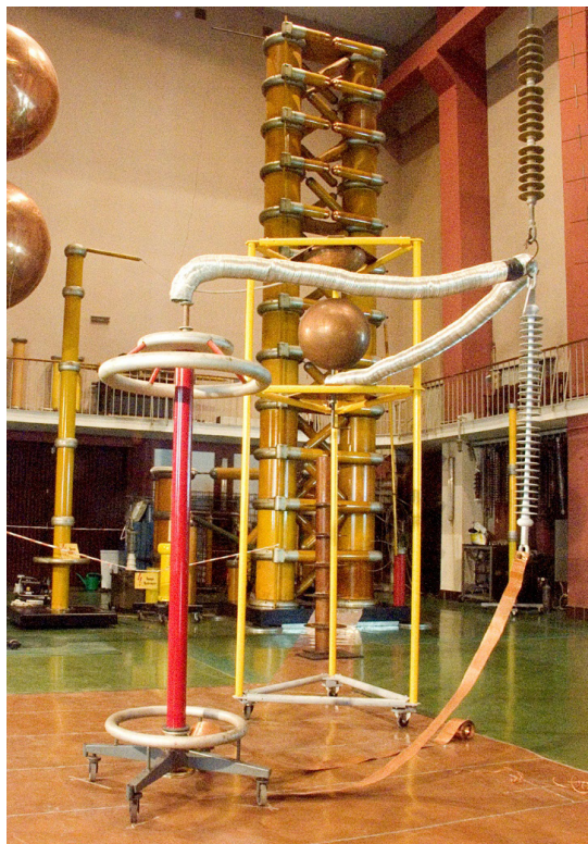
Rys. 11.2. Układu probierczy wytwarzania stromo narastających udarów napięciowych w Hali Wysokich Napięć PWr.
