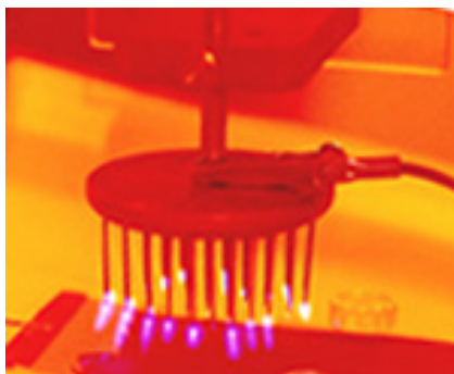
Rys. 6.4. Wyładowanie ulotowe z elektrody wieloostrzowej [189]
