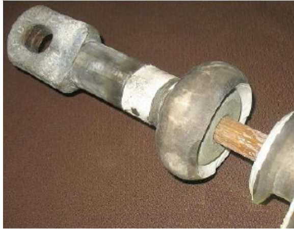
Rys. 12.11. Izolator po próbie mechanicznej; widoczne wysunięcie rdzenia z okucia
