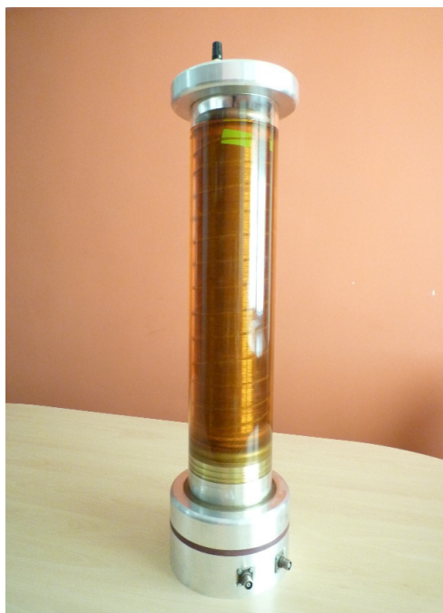
Rys. Z.2. Specjalny dzielnik napięcia udarowego
