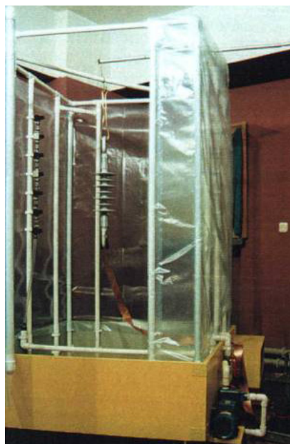
Rys. 9.7. Komora deszczowa w Laboratorium Wysokich Napięć PWr.
