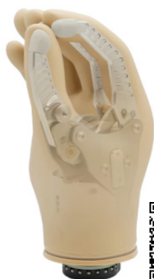
Mioelektryczna proteza ręki Myo Kinisi (producent RSL STEEPER, dystrybutor OrtoCentrum)
