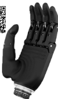
Przedramię do protez mioelektrycznych Whizzlink (producent Glaze Prosthetics) w technologii druku 3D
