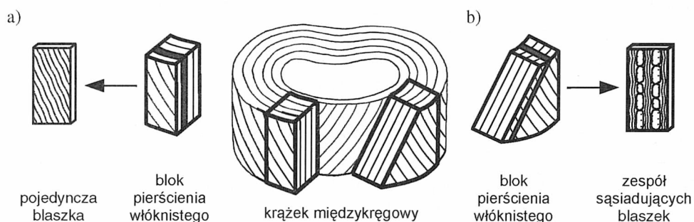
Rys. 6.1. Schemat uzyskiwania próbek: a) pojedyncza blaszka pierścienia włóknistego (próbki obwodowe), b) zespół kolejnych, sąsiadujących ze sobą blaszek w przekroju poprzecznym (próbki promieniowe)
