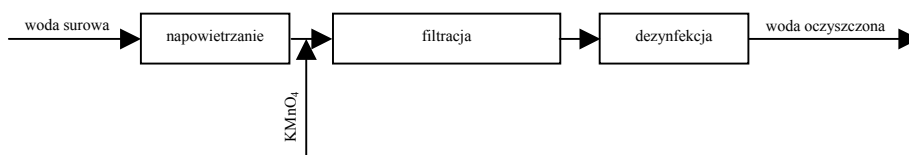
Rys. 9. Układ oczyszczania wód podziemnych z utlenianiem chemicznym z użyciem nadmanganianu potasu
