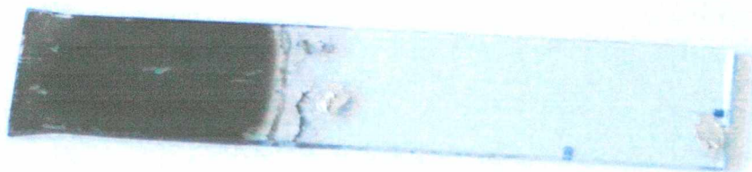
Rysunek 15. Zdjęcie poli( N -nonylo-3,6-bis(2-tiofeno)karbazolu) otrzymanego w wyniku elektrochemicznej polimeryzacji
