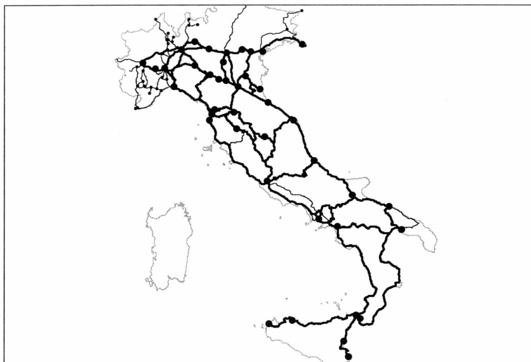
Rysunek 26. Poddana modelowaniu sieć kolejowa Włoch oraz przebieg najkrótszych tras międzyrejonowych.
