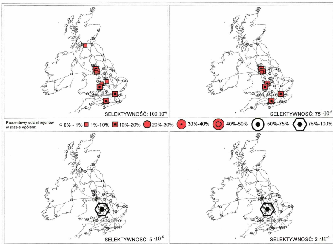
Rysunek 44. Stany równowagi w symulacjach sieci drogowej Wielkiej Brytanii przy początkowym równomiernym rozkładzie mas i selektywnościach 100, 75, 5 i 2 \cdot 10^{-6} .
