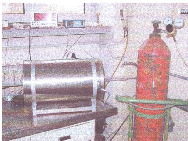
Rys. 27. Poziomy reaktor kwarcowy służący do azotowania próbek przy użyciu gazowego amoniaku.
